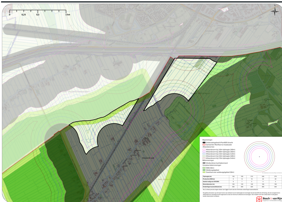
Figuur 2 : De doorwerking van de afstandsnorm van 2 keer de tiphoogte voor verschillende windturbineformaten in zoekgebied 8.
