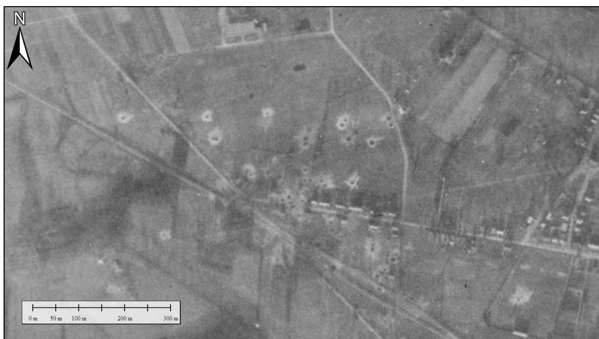
Figuur 4: De situatie rondom het spoorwegknooppunt te Winterswijk op de luchtfoto van 24 december 1944. De lichtgekleurde verstoringen met zwarte middelpunten zijn allen inslagkraters van afwerpmunitie. Rondom de spoorwegkruising zijn tientallen bommen neergekomen. Luchtfotonummer 4230.
