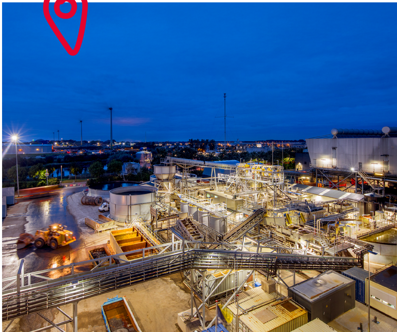
De bodemas-wasinstallatie maakt het mogelijk om bodemas te hergebruiken. Dit doet HVC samen met Boskalis Environmental.
