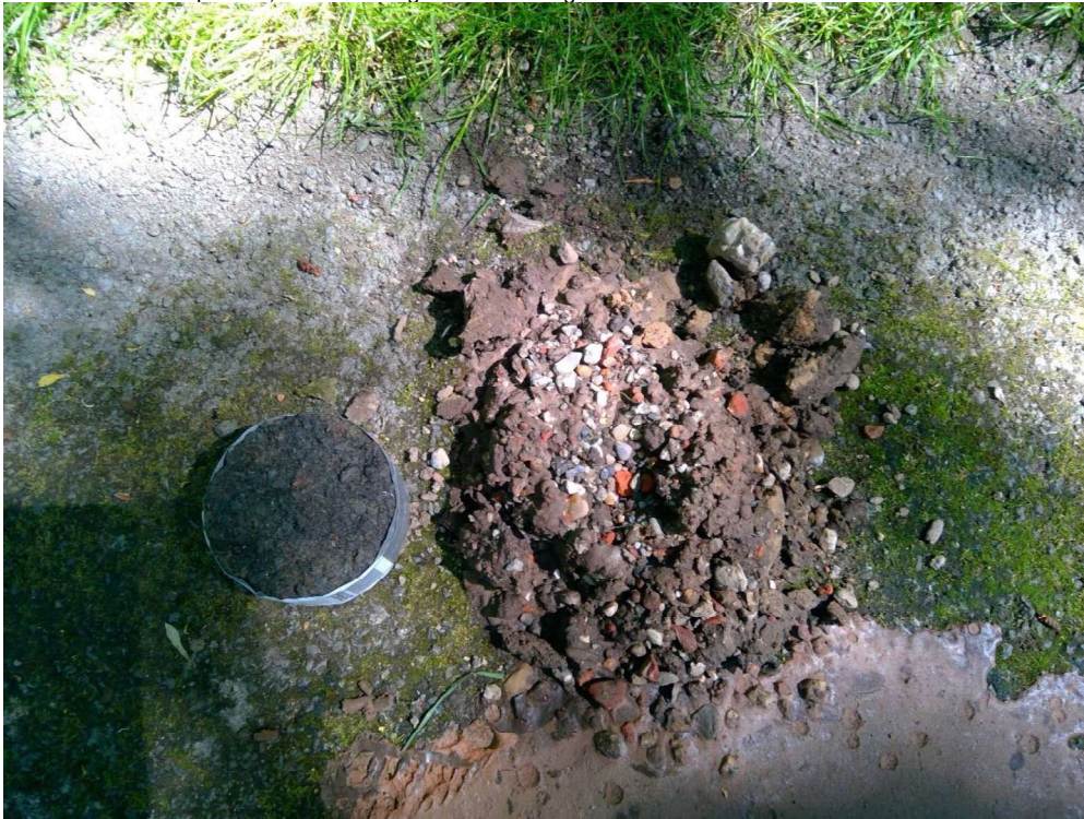
Foto 4: Onderzoekspunt 05, halfverharding en fundatielaag
