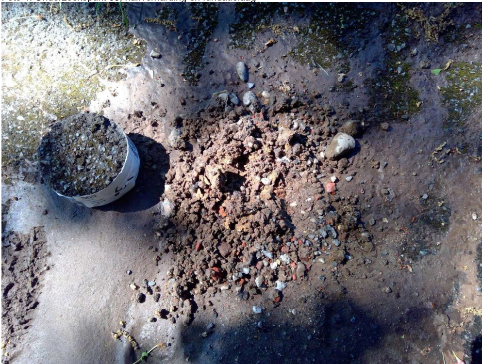
Foto 4: Onderzoekspunt 05, halfverharding en fundatielaag
