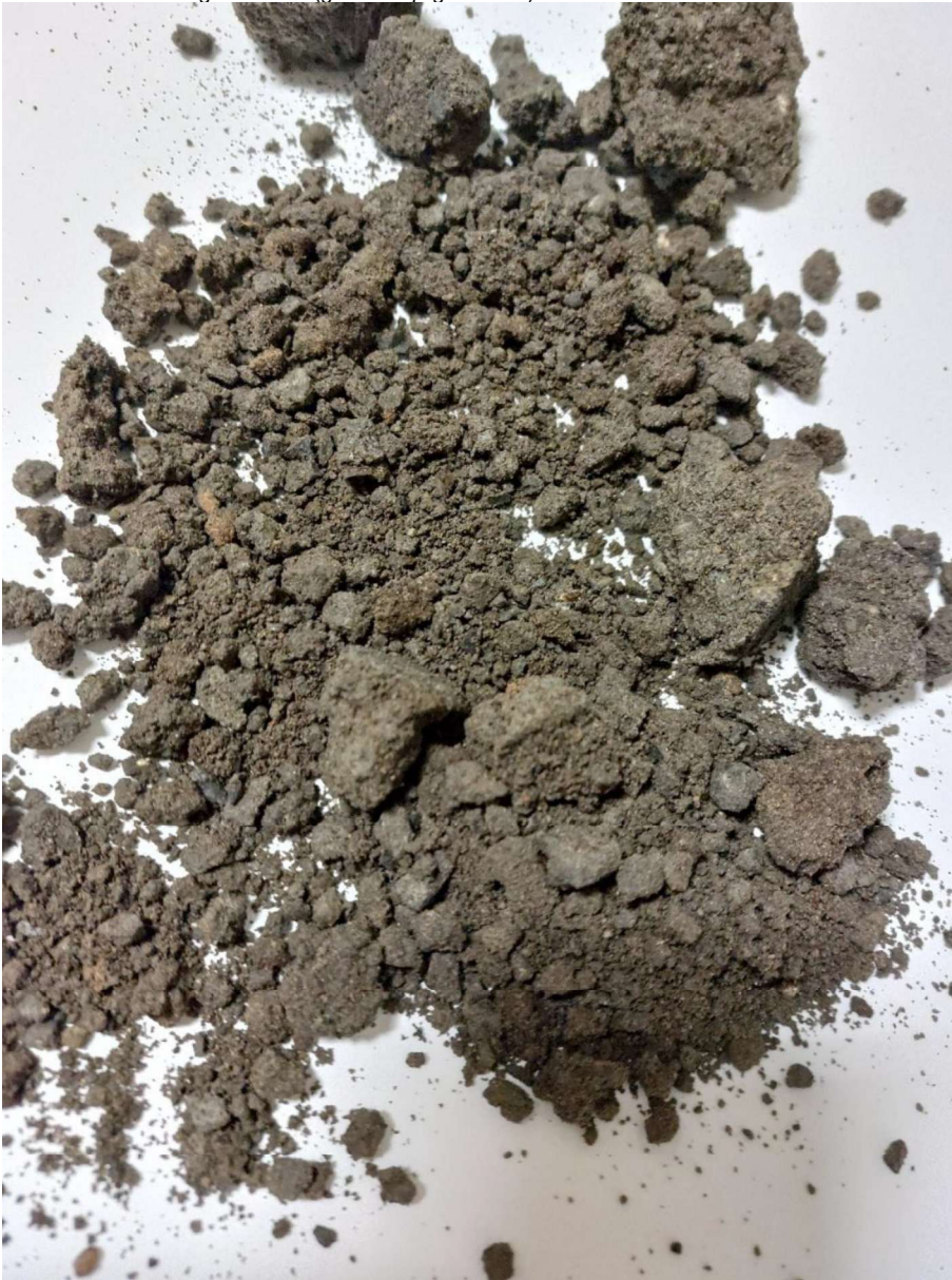
Foto 2: Halfverhardingsmateriaal (gedeeltelijk gebonden)
