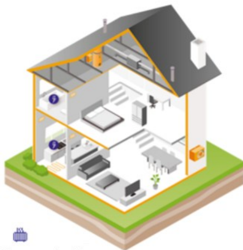
Figuur 2.2 Schematische weergave van een lucht-water warmtepomp (Bron: De WarmeTransitieMakers)
