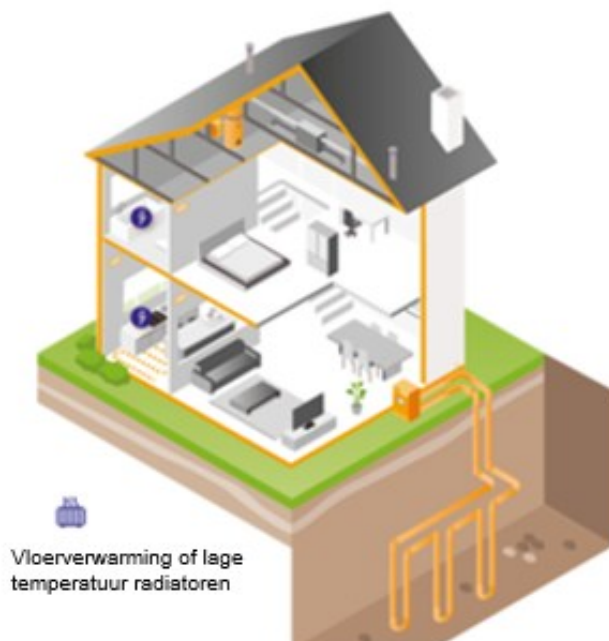
Figuur 2.4 Schematische weergave van een bodem-water warmtepomp (Bron: De Warme TransitieMakers)
