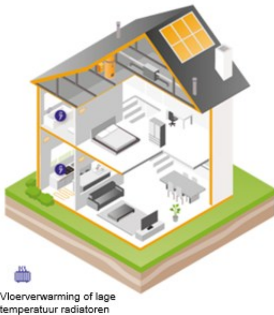
Figuur 2.5 Schematische weergave van een PVT- warmtepomp (Bron: De WarmeTransitieMakers)
