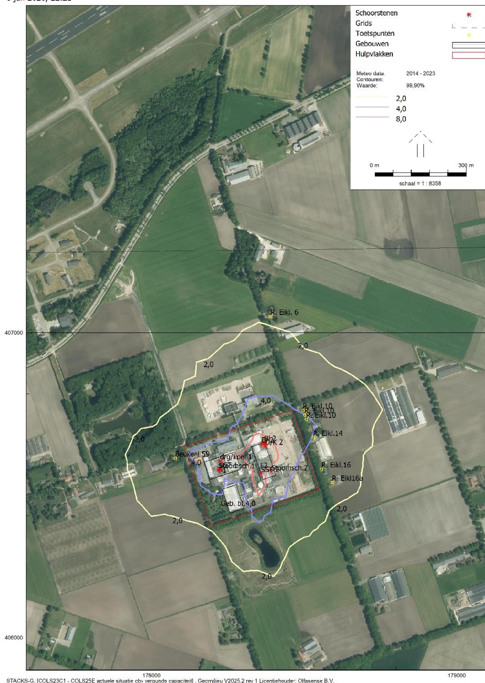
Figuur g Geurcontouren van 2, 4 en 8 ou_E(H)/m^3 als 99,9-percentielwaarde als gevolg van Peka Kroef te Odiliapeel in de actuele situatie
