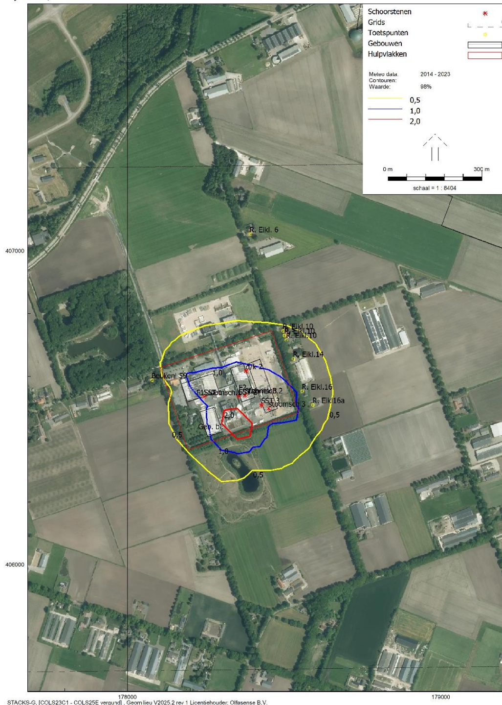
Figuur d Geurcontouren van 0,5 ; 1,0 en 2,0 ou_E(H)/m^3 als 98-percentielwaarde als gevolg van Peka Kroef te Odiliapeel in de vergunde situatie
