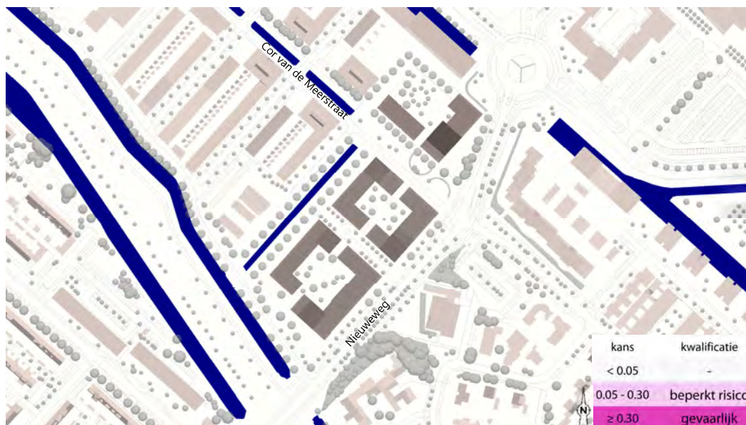
f 3.6 Windgevaar in de aangepaste geplande bebouwing
