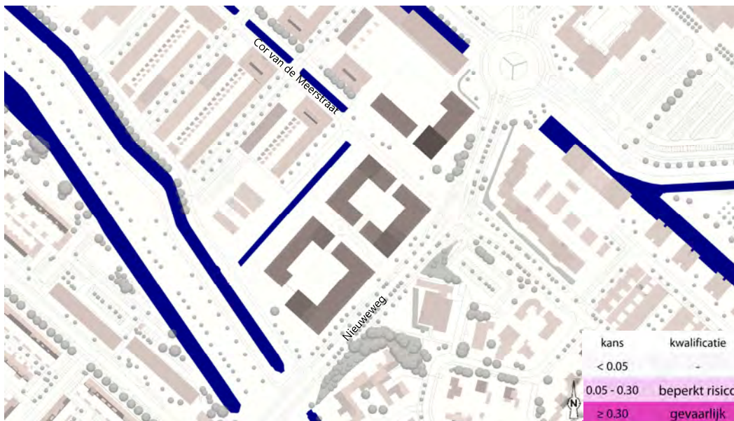
f 3.3 Windgevaar in de oorspronkelijk geplande bebouwing
