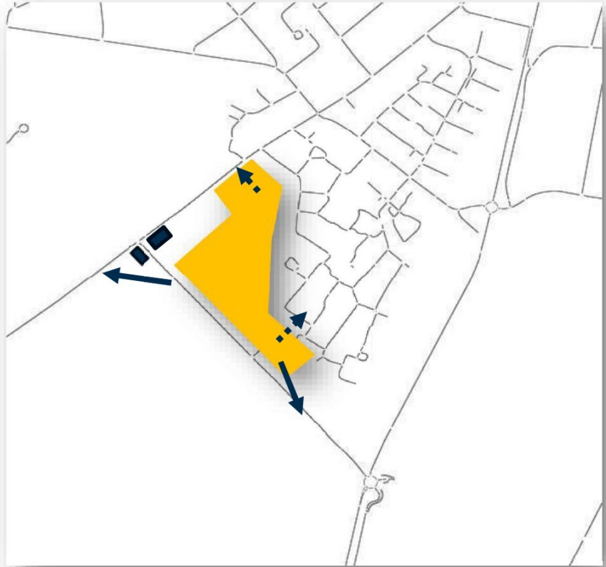
Figuur 9. Verleggen aansluiting Hovergelei op de Beeselseweg in zuidelijke richting.
