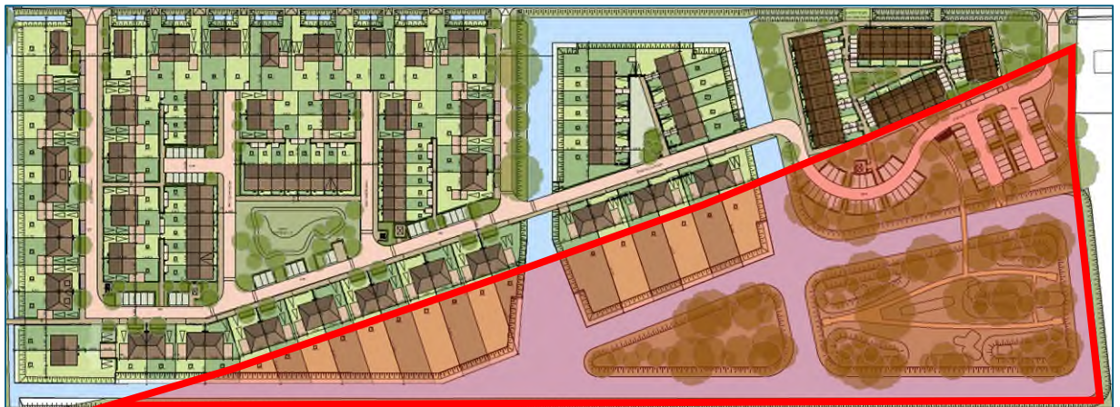
Figuur 3-3: Ligging LIB-zone 5 (rood) ten opzichte van de geprojecteerde woningbouw (Bron: Stedenbouwkundig plan 2024-06-06)
