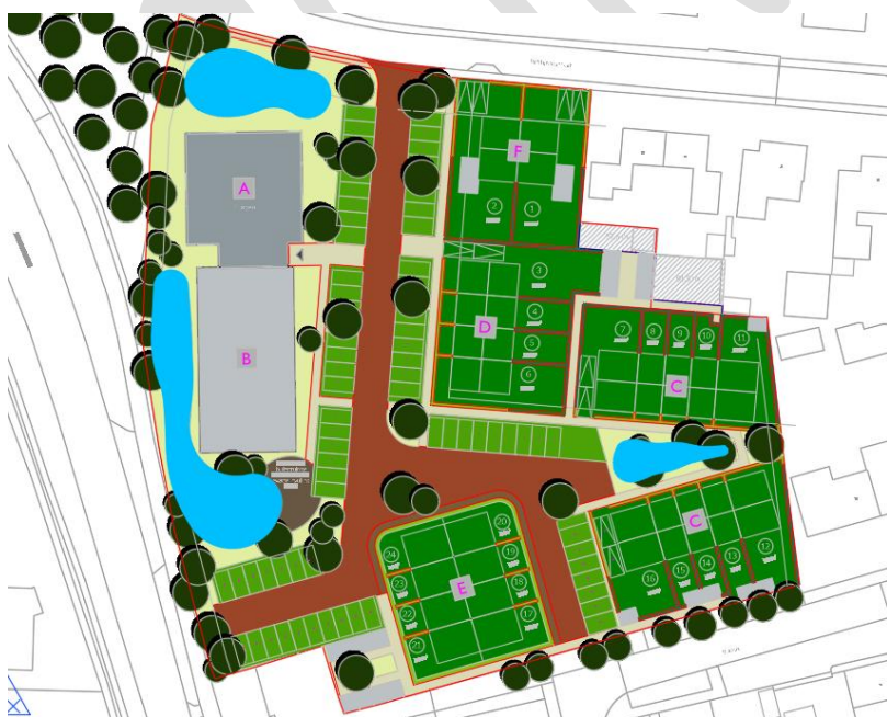
Afbeelding 9 Schets van de mogelijke locaties van de bovengrondse infiltratievoorzieningen
