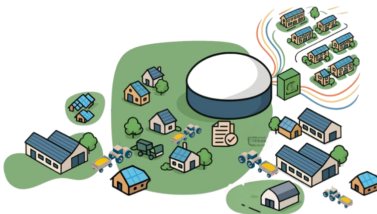
Figuur 8: Schetsmatige weergave van een grootschalige centrale vergister
