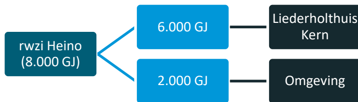
Afbeelding 4.3 Voorgestelde verdeling voor de warmtelevering vanuit rwzi Heino
