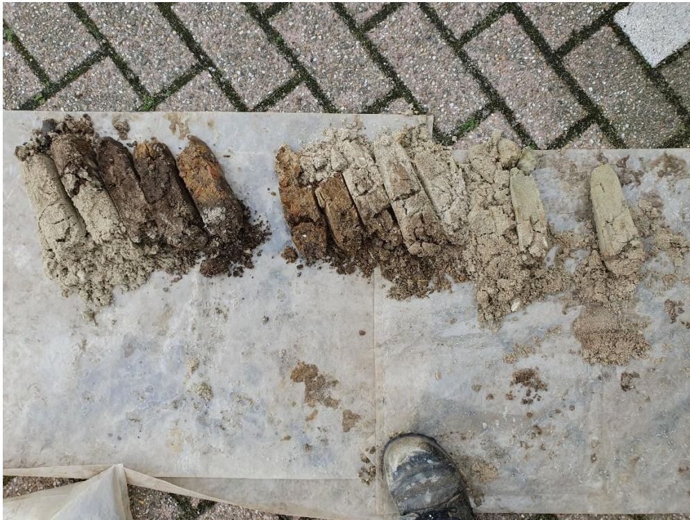
Foto's van boring 2, respectievelijk van 0 tot 130 cm.
