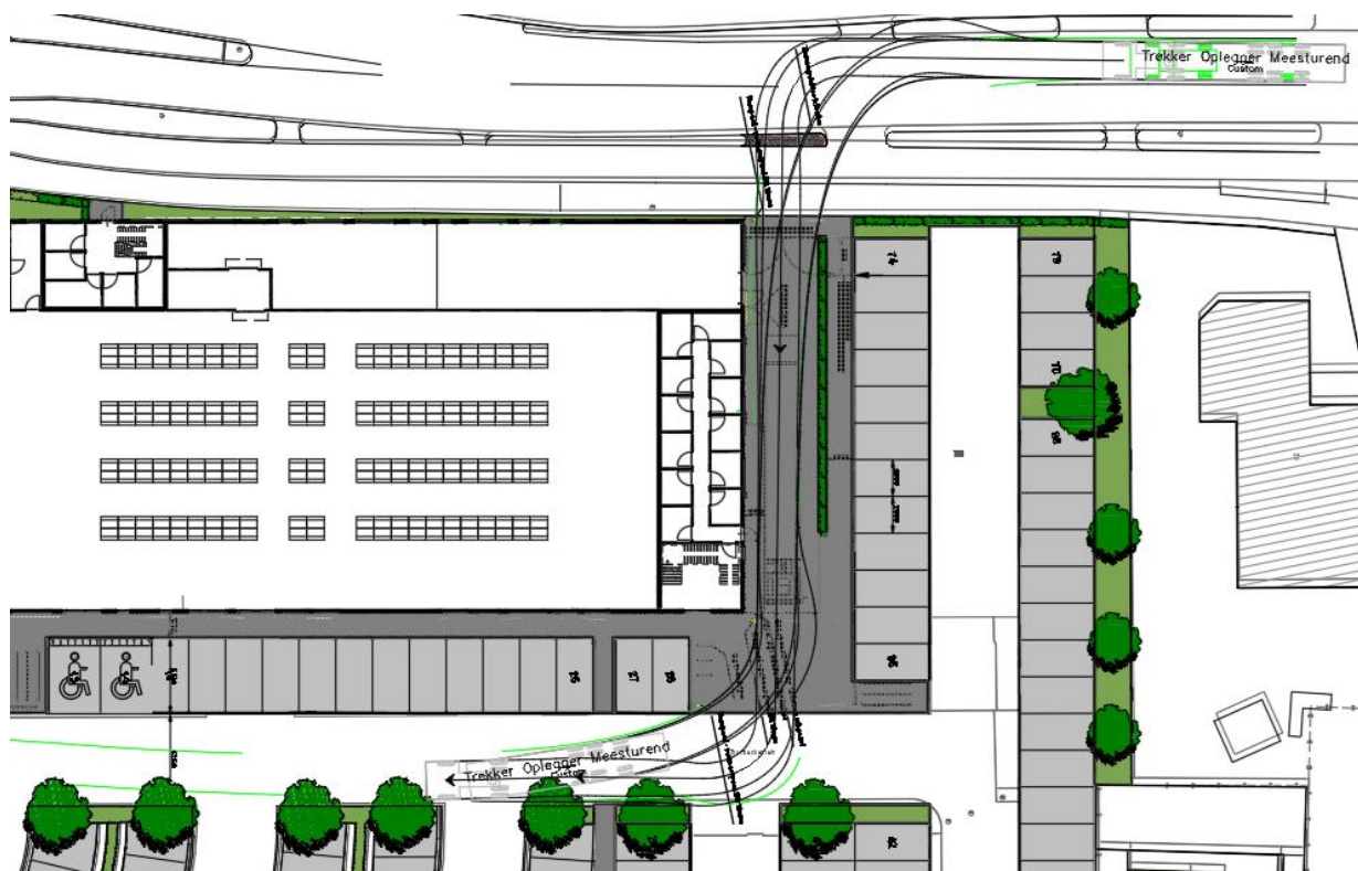
Afbeelding 3.4. Rijcurve aanrijdend vrachtverkeer naar laad en loslocatie
