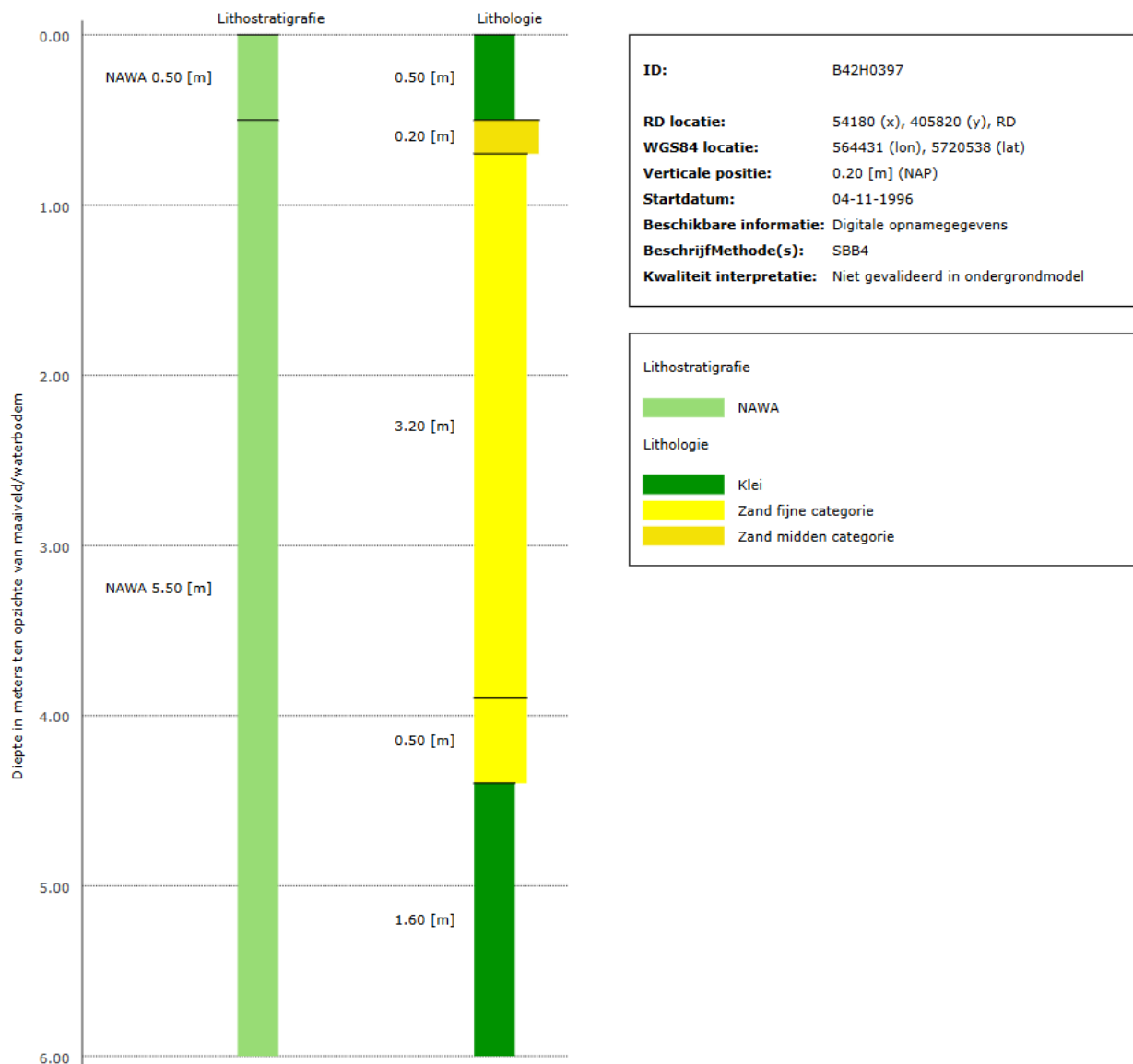
Figuur 5-10: Boorprofiel locatie 10.
