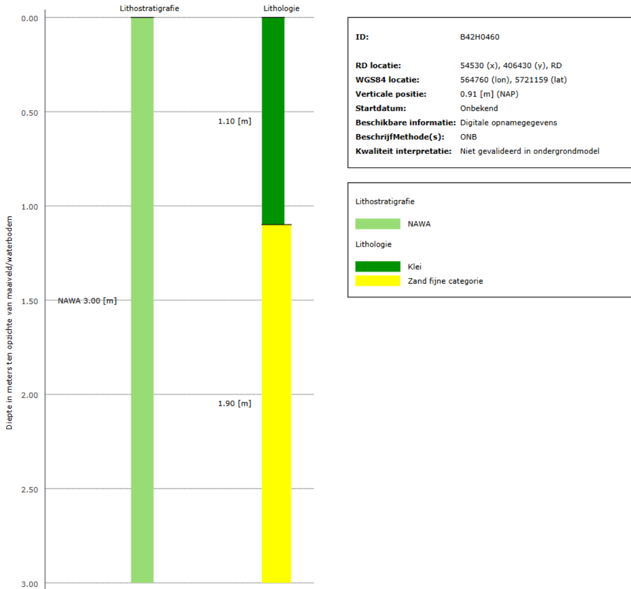
Figuur 5-7: Boorprofiel locatie 7.
