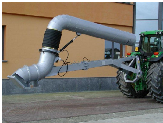
Figuur 1: Voorbeelden van noodpompen (links een trekkerpomp (capaciteit tot orde 30 m 3 /min) en rechts een Betsy-pomp 300 (capaciteit 20 m 3 /min)).
