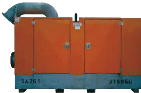
Figuur 1: Voorbeelden van noodpompen (links een trekkerpomp (capaciteit tot orde 30 m 3 /min) en rechts een Betsy-pomp 300 (capaciteit 20 m 3 /min)).
