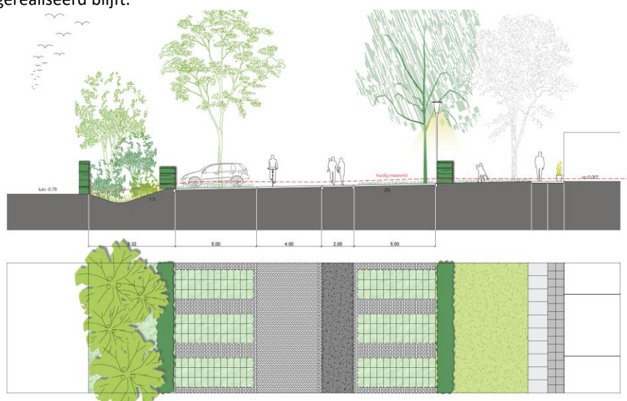
Afbelding 5.5: Dwarsprofiel noordoostzijde plangebied (bron: KuiperCompagnons)
