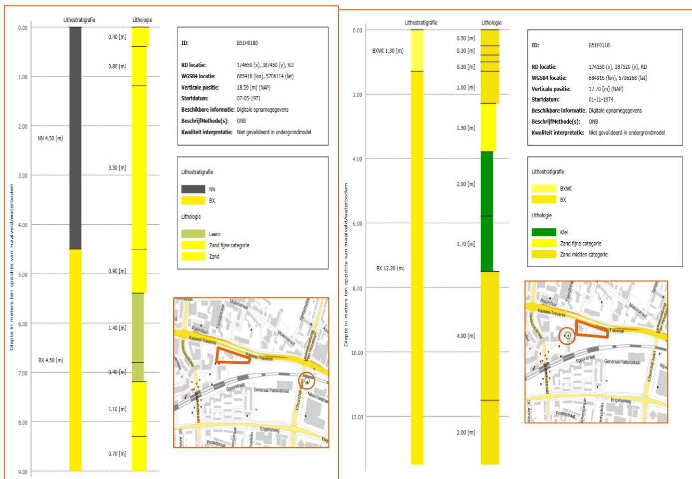
Figuur 4-9 Links bodemprofiel (B51H0180) ten oosten van het projectgebied. Rechts bodemprofiel (B51F0118) ten westen van het projectgebied. De rode cirkels geven de locaties van de boringen weer. De zwarte omlijning geeft het projectgebied weer.
