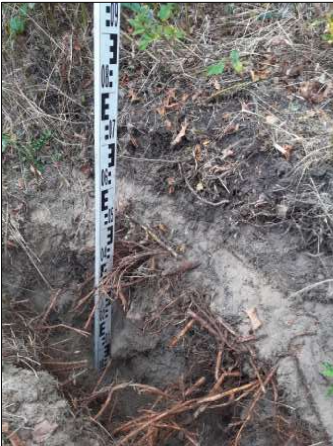
Afbeelding 8: Resultaten van de profielsleuf op een afstand van 70 centimeter van de stam, ten behoeve van de realisatie van ontwerp 1.
